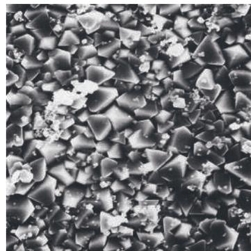
Wachsende und ungleichmäßige Magnetitschicht bei herkömmlichen Konditionierungsmitteln
