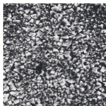
Nach Umstellung auf FINEAMIN®: Glatte, sehr dünne und stabile Magnetitschicht optimiert den Wärmeübergang und Korrosionsschutz
